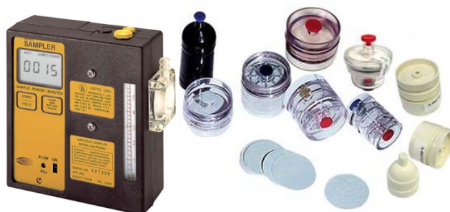
Figura 9 – Bomba de amostragem, cassetes e filtros de membrana ( http://www.skcinc.com , 2015)
