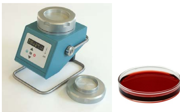
Figura 7 - Bomba para amostragem bacteriológica do ar ( http://plasmatronics.com.br/bomba.html ).
