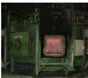
Sinterização das cascas cerâmicas
