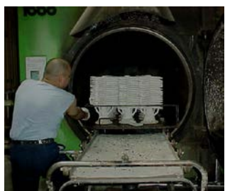
Cascas cerâmicas após extracção de cera
