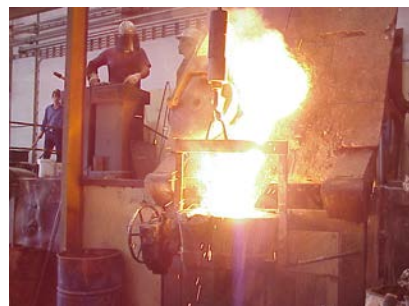
Vazamento do forno para o colherão
