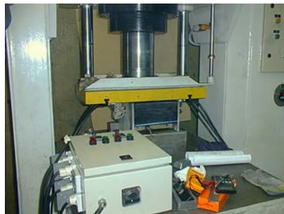
Compressão do metal em estado líquido por ação da prensa
