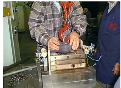
Remoção da peça após solidificação
