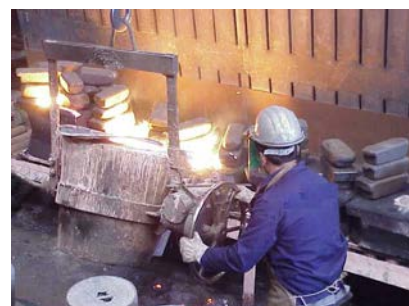
Operação de vazamento
