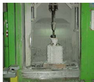
Desmoldação – remoção da cerâmica
