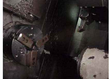
Pormenor do interior do torno CNC
