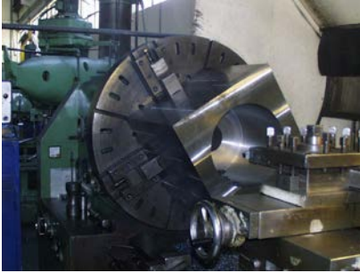
Maquinagem de superfícies cilíndricas interiores
